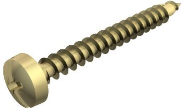
In acciaio temprato, zincato galvanicamente e giallo passivato, così come Hostaflon-rivestito, panhead, con la combinazione di Philips e testa a taglio (Pozidrive dimensione 2, salvo Ø 6 mm Pozidrive dimensione 3).
