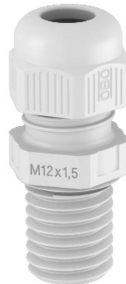
Il modo più comodo e veloce per fornire scarico della trazione e tenuta con pressacavi scatole di derivazione e custodie è con il provato e di fiducia V-TEC VM pressacavi da OBO. Con il sistema integrato di labbro di tenuta e la speciale OBO lamella tecnologia, classe di protezione IP68 è raggiunto. Scarico della trazione e la tenuta sono stati testati secondo la norma DIN EN 50262.
