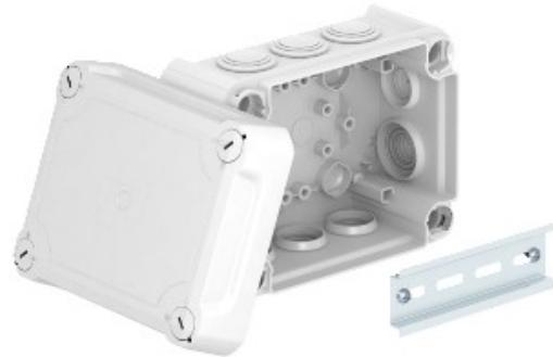
Le scatole di derivazione sono costituiti di materiale termoplastico. Le parti inferiori sono costituiti da impatto-resistente polipropilene, il coperchio della scatola è fatta da estremamente resistente, resistente agli urti in policarbonato. L'alta resistenza all'urto IK 10 -5°C si vede anche questo.
