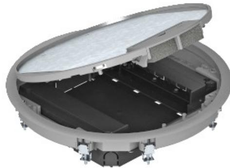
GESR9 servizio di presa con una struttura fissa altezza di 55 mm. Con due montato plug alloggiamenti per montaggio verticale di Modul 45 dispositivi e quattro ceppo rilievi. Due di installazione di telai di montaggio Modul 45 dispositivi. I dati moduli sono montati utilizzando una piastra di montaggio opzionale MPMT45. Il servizio di presa è dotata di staffe di fissaggio universale.
