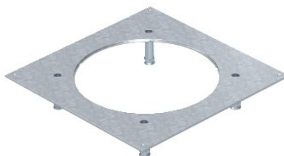
Pesante-dovere di montaggio coperchio per UZD350-3 per l'installazione di turno pesanti cassette di dimensione nominale R7. Con quattro pesanti sostiene che sono collegati con il montaggio del coperchio e sono regolabili in altezza. Regolazione dell'altezza di bulloni con dadi di bloccaggio per fissare l'altezza. Installazione di apertura di 3 mm, incasso per la successiva soppressione di blocco con coperchio piastra cieca.
