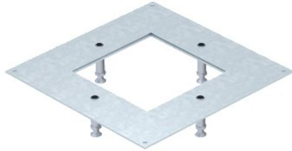
Pesante-dovere di montaggio coperchio per UZD350-3 per l'installazione di un quadrato pesanti cassette di dimensione nominale di 4. Con quattro regolabile in altezza pesanti supporta, permanentemente collegato al montaggio del coperchio. Regolazione dell'altezza di bulloni con dadi di bloccaggio per fissare l'altezza. Installazione di apertura di 3 mm, incasso per la successiva soppressione di blocco con coperchio piastra cieca.
