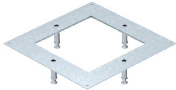
Pesante-dovere di montaggio coperchio per UZD250-3 per l'installazione di un quadrato pesanti cassette di dimensione nominale di 4. Con quattro regolabile in altezza pesanti supporta, permanentemente collegato al montaggio del coperchio. Regolazione dell'altezza di bulloni con dadi di bloccaggio per fissare l'altezza. Installazione di apertura di 3 mm, incasso per la successiva soppressione di blocco con coperchio placca cieca.
