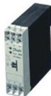
La stella-triangolo timer ha un built-in pausa di 30ms di commutazione motore da star configurazione a delta run. I temporizzatori elettronici con il loro design robusto e molti built-in funzioni sono l'ideale per gli Oem e i quadristi. Facile impostazione del tempo di immunità ai disturbi Elettrici Meccanici resistenza ad urti e vibrazioni intervalli di Tempo: 0.3 s 30 s Compact dimensioni standard DIN o adattatore di montaggio
