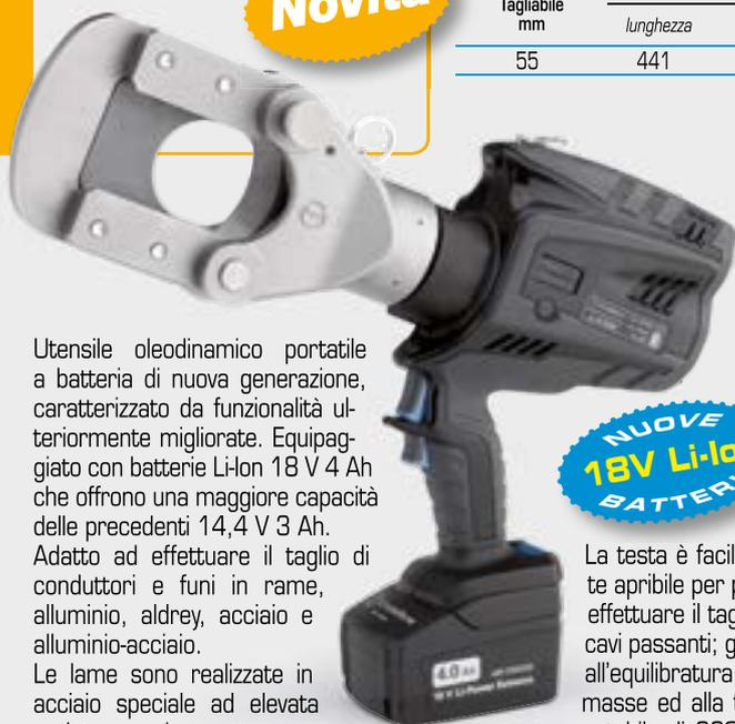
Utensile oleodinamico portatile a batteria di nuova generazione, caratterizzato da funzionalità ulteriormente migliorate. Equipaggiato con batterie Li-Ion 18 V 4 Ah che offrono una maggiore capacità delle precedenti 14,4 V 3 Ah. Adatto ad effettuare il taglio di conduttori e funi in rame, alluminio, aldray, acciaio e alluminio-acciaio.
