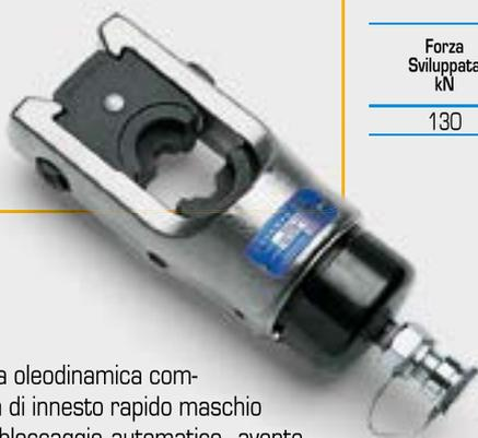
Testa oleodinamica completa di innesto rapido maschio con bloccaggio automatico, avente gli stessi campi d'utilizzo dell'utensile HT 131-UC. Consente quindi, con adeguati accessori, la realizzazione di connessioni elettriche su cavi in alluminio mediante la tecnica della punzonatura profonda in matrice chiusa.
