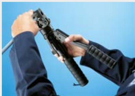
L'operatore può azionare l'utensile con una sola mano, utilizzando l'altra per il corretto posizionamento del connettore.
