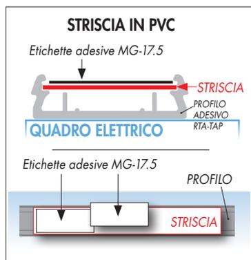
Le strisce di base per componenti modulari sono ideali per ottenere un allineamento perfetto delle targhette MG-17,5 o per comporre strisce lunghe fino a 430 mm, da applicare direttamente sul quadro o da inserire all'interno degli appositi profili.
