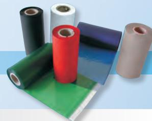
I nastri di stampa sono una componente molto importante per raggiungere il risultato finale. I nastri monocromatici **MG2-ETR** sono forniti in sviluppo da 200 metri lineari, con larghezza di 120 mm. Garantiscono elevata resistenza all'abrasione, allo sfregamento e all'azione degli agenti chimici (esano, alcool etilico, ...) ed atmosferici (raggi UV, umidità, ...).
