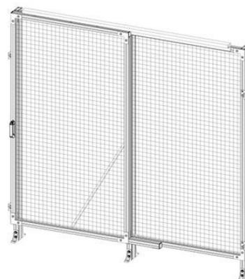
Quick-Guard E slidingdoor sezione con 44x44/44x88mm profili. Compresi i componenti profili in policarbonato, sospensione ruote, maniglia di componenti, staffe da pavimento e netlocks. Altezza totale 2200 millimetri, larghezza della porta 1100mm c-profili c
