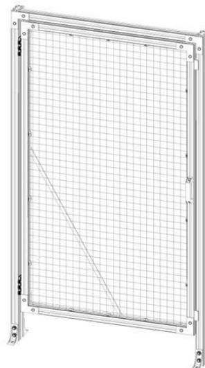
Quick-Guard E sezione di porta con 44x44/44x88mm profili. Compresi i componenti profili, staffe da pavimento, netlocks, pre-montato doorleaf con rete elettrosaldata. Totale altezza 2000 mm, larghezza 1100 mm c-c profili.
