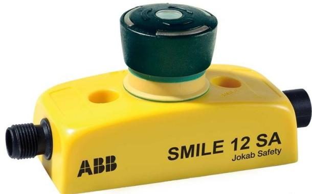
L'arresto della macchina(tasto Nero) nel Sorriso armadio, 2 x NC, LED di Stato pulsante, 1 x M12 5-pin connettore maschio e 1 x M12 5-pin connettore femmina.
