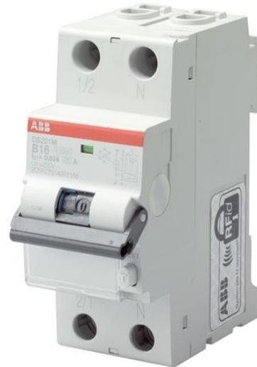
Il DS201 serie RCBO è un 1P+N in due moduli dispositivo per la protezione dell'utente finale monofase circuiti contro i sovraccarichi e i cortocircuiti; protezione contro gli effetti dell sinusoidale alternata a terra le correnti di guasto; protezione contro i contatti indiretti e protezione addizionale contro i contatti diretti (sensibilità = 30 mA).
