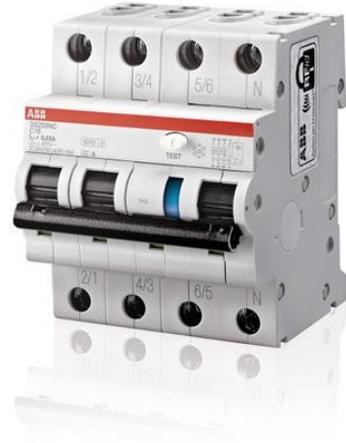
DS203NC 3P+N interruttore per correnti di guasto con protezione da sovracorrente (RCBO) in quattro moduli per la protezione contro le correnti di cortocircuito, sovraccarico, guasto a terra le correnti, i contatti indiretti, protezione aggiuntiva contro i contatti diretti (30 mA le versioni).
