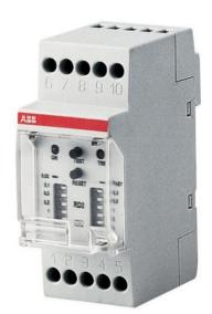
Corrente residua monitor (Rcm) con trasformatore esterno in grado di rilevare correnti di dispersione. Attraverso minidip è possibile impostare la sensibilità e tempo di intervento. Secondo lo stesso diametro, trasformatori sono realizzati in un'unica versione per tutti i relè di valori di sensibilità.
