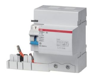
Il RCD Blocco DDA800 serie assicura la protezione di persone e impianti contro la corrente di guasto a terra. Una grande offerta per standard istantanea e selettivo AC e tipi è completato con alcune configurazioni per applicazioni speciali. Questo prodotto è adatto per il montaggio con MCBs S800 serie fino a 63A.
