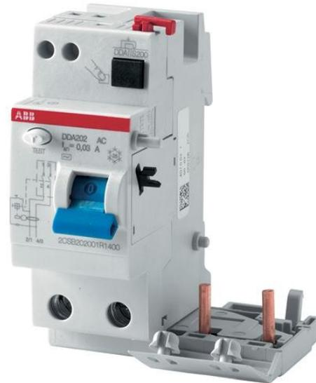
Il RCD blocco DDA200 serie è adatto per il montaggio con MCBs S200 serie. Assicura la protezione contro gli effetti dell' sinusoidale alternata e continua pulsante terra le correnti di guasto con un intenzionale ritardo d'intervento, al fine di realizzare la selettività con a valle istantanea dispositivi. Applicazioni: commerciale, industriale.
