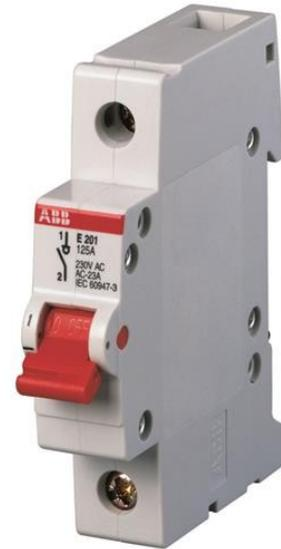
Questi dispositivi sono adatti per il comando di carichi e sono realizzate secondo EN 60947-3 e EN 60669-1, rispettivamente. Rimozione veloce senza smontare le sbarre. Viti di fissaggio con incasso/testa piatta. Pozidrive dimensione 2. Add-on fino a 3 contatti ausiliari S2C-H6R possibile integrazione posare un bordo per il sistema di etichettatura di ILS. Dispositivo di bloccaggio di accessori non autorizzati ON/OFF. Approvazione: VDE, CCC, KEMA
