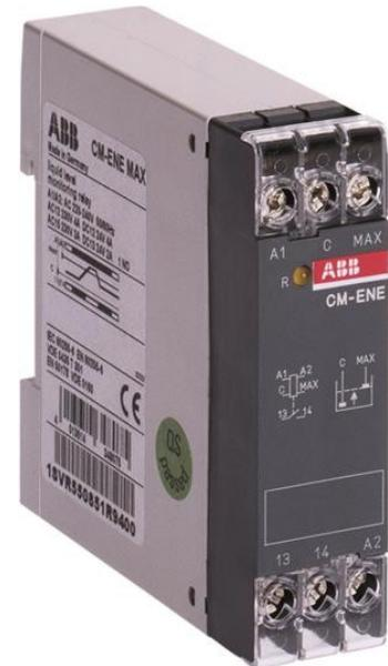
Livello del liquido relè CM-ENE MAX larghezza 22,5 mm, protezione di troppo-pieno, sensibilità 0-100kOhm fisso, A1-A2=220-240VAC, 1 n/o (a circuito chiuso principio)
