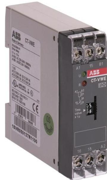
Il CT-la nostra struttura è una singola funzione elettronici relè di tempo il CT-E timer di intervallo. Esso fornisce un impulso (intervallo) funzione con un intervallo di tempo da 3 s a 300 s. Questo relè a tempo opera con una potenza di controllo tensione di alimentazione di 24 V AC / DC / 220 - 240 V in C.A. e 1 c/o (SPDT) uscita nominale 250 V / 4 A.
