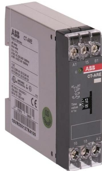
Il CT-è una singola funzione elettronici relè di tempo il CT-E timer di intervallo. Esso fornisce un tempo di ritardo (vero ritardo su break) funzione senza tensione ausiliaria e con un intervallo di tempo da 0,1 s a 10 s. Questo relè a tempo opera con una potenza di controllo tensione di alimentazione 110 - 130 V C.A. e 1 c/o (SPDT) uscita nominale 250 V / 4 A.
