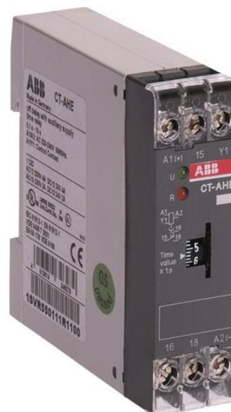
Il CT-AHE è una singola funzione elettronici relè di tempo il CT-E timer di intervallo. Esso fornisce un OFF-delay (ritardo di pausa) funzione con un intervallo di tempo da 3 s a 300 s. Questo relè a tempo opera con una potenza di controllo tensione di alimentazione 220 - 240 V in C.A. e 1 c/o (SPDT) uscita nominale 250 V / 4 A. Un ingresso di controllo funziona con la tensione (non mobile) di attivazione.
