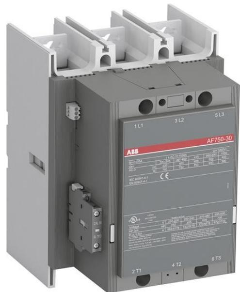
3-fase di Contattore adatto per varie applicazioni come Motore di avviamento, di Isolamento, di By-pass e la Distribuzione di applicazioni fino ad un max di 1000 V. Operato con ampia gamma di tensione di controllo 100-250 V, AC/DC
