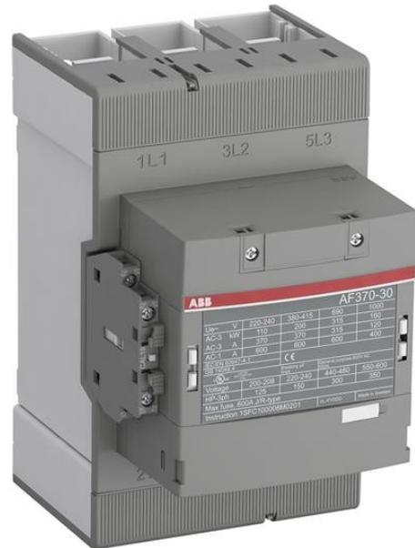
3-fase di Contattore adatto per varie applicazioni come Motore di avviamento, di Isolamento, di By-pass e la Distribuzione di applicazioni fino ad un max di 1000 V. Operato con ampia gamma di tensione di controllo 100-250 V, 50/60 Hz DC
