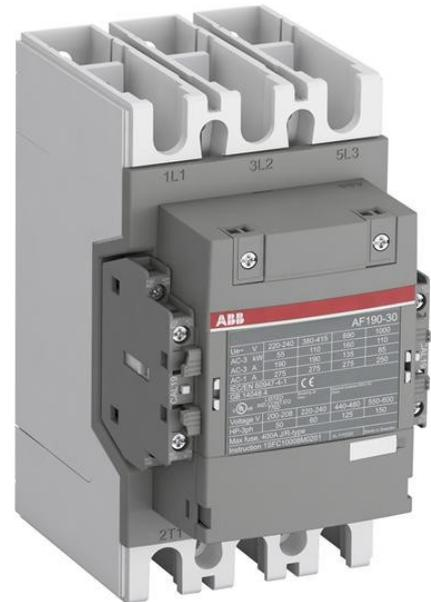
3-fase di Contattore adatto per varie applicazioni come Motore di avviamento, di Isolamento, di By-pass e la Distribuzione di applicazioni fino ad un max di 1000 V. Operato con ampia gamma di tensione di controllo 24-60 V, 50 e 60 Hz, 20-60 V DC
