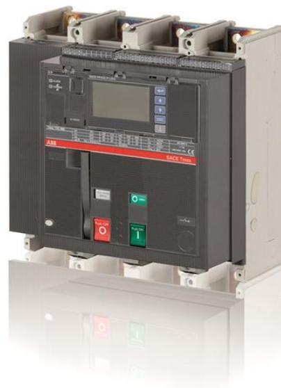
C. INTERRUTTORE TMAX T7L 1000 FISSA a QUATTRO POLI CON parte ANTERIORE TERMINALI E L'ENERGIA accumulata MECCANISMO di FUNZIONAMENTO E a STATO SOLIDO RILASCIO di AC PR332/P-LSIRc R 1000
