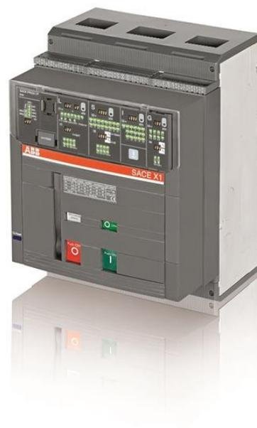
C. INTERRUTTORE EMAX X1N 1000 FISSO a TRE POLI CON parte ANTERIORE TERMINALI E a STATO SOLIDO RILASCIO di AC PR331/P-LI R 1000 DOTATO di: 4 CONTATTI AUSILIARI E C. INTERRUTTORE IN POSIZIONE di APERTO-CHIUSO
