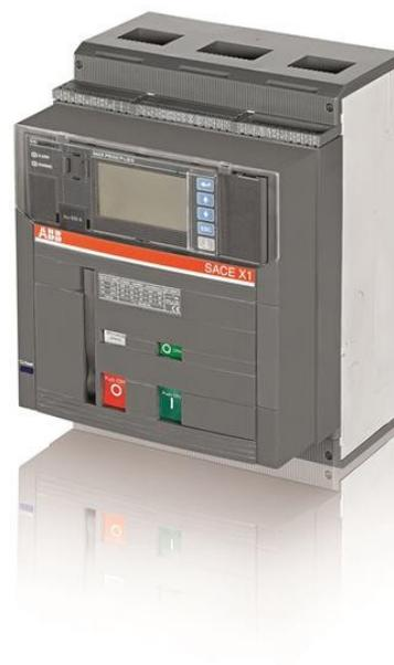
C. INTERRUTTORE EMAX X1B 800 FISSO a TRE POLI CON parte ANTERIORE TERMINALI E a STATO SOLIDO RILASCIO di AC PR332/P-LSI R 800 DOTATO di: 4 CONTATTI AUSILIARI E C. INTERRUTTORE IN POSIZIONE di APERTO-CHIUSO
