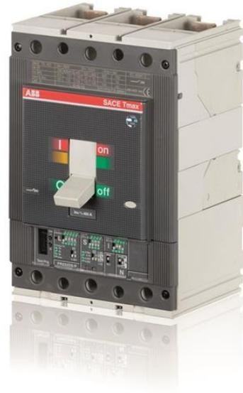
C. INTERRUTTORE TMAX T5V 630 1150V AC FISSO a TRE POLI CON parte ANTERIORE TERMINALI PER CAVO Cu a STATO SOLIDO E RILASCIO di AC PR222DS/P-LSI R 630
