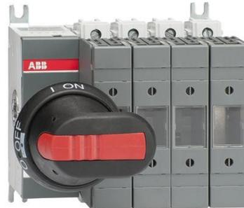
Comprende il terminale kit bulloni, un nero ON-OFF impugnatura in plastica e asta come standard. Il manico è protetto IP65, lucchettabile in posizione di riposo e con blocco porta in posizione. L'asta è regolabile per una vasta gamma di profondità di installazione.
