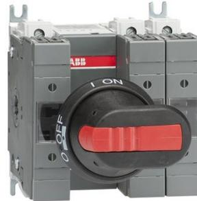
Comprende il terminale kit bulloni, un nero ON-OFF impugnatura in plastica e asta come standard. Il manico è protetto IP65, lucchettabile in posizione di riposo e con blocco porta in posizione. L'asta è regolabile per una vasta gamma di profondità di installazione.
