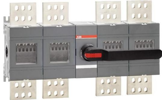
Comprende il terminale kit bulloni, un nero ON-OFF impugnatura in plastica OHB200J12P e l'albero OXP12x280 come standard. Il manico è protetto IP65, lucchettabile in posizione di riposo e con blocco porta in posizione. L'asta è regolabile per una vasta gamma di profondità di installazione.
