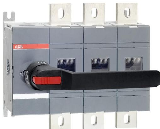
Tra un nero ON-OFF impugnatura in plastica e asta come standard. Il manico è protetto IP65, lucchettabile in posizione di riposo e con blocco porta in posizione. L'asta è regolabile per una gamma di profondità di installazione.
