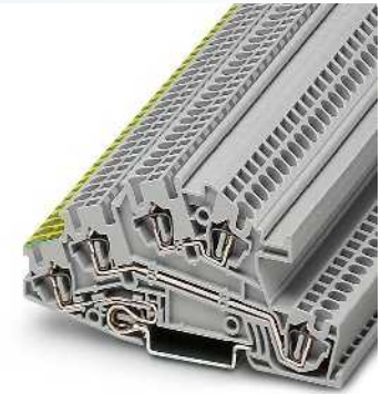
2,5 (4) mm 2 , 24 A, Dreistockklemme, 2 x Außenleiter L, 1 x PE
