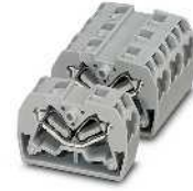
2,5 (4) mm 2 , 30 A, Durchgangsklemme, 4 Anschlüsse, zur Blockbildung
