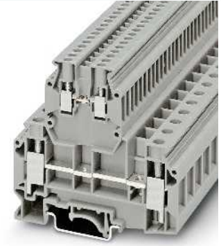
10 (16) mm 2 , 76 A, Doppelstockklemme, obere Etage mit 2 x 2,5 mm 2 Durchgangsklemmen
