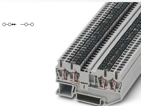
2,5 (4) mm 2 , 28 A, Durchgangsklemme, 4 Anschlüsse, mit geteilter Stromschiene
