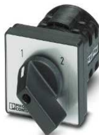
2,5 (2,5) mm 2 , 20 A, Umschalter ohne 0 - Stellung, mit galvanisch getrennten Kontakten
