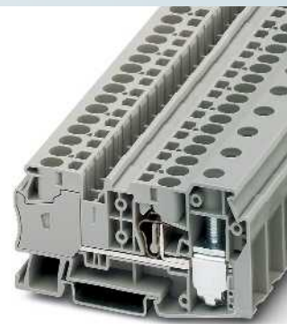
35 (50) mm 2 , 125 A, Einspeiseklemme, 4 Abgänge 10 mm 2
