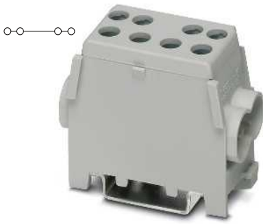
35 (35) mm 2 , 125 A, Hauptleitungs-Abzweigungsklemme, 2 Abgänge 25 mm 2
