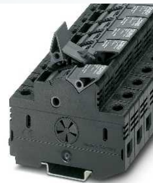
16 (25) mm 2 , 32 A, Hebelsicherungsklemme für Midget-Sicherungen 10,3 x 38 mm
