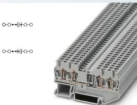
2,5 (4) mm 2 , 0,5 A, Diodenklemme, 4 Anschlüsse
