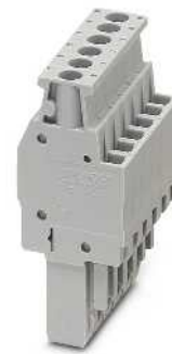
2,5 (4) mm 2 , 24 A, Stecker, Anschluss rechtwinklig zur Steckrichtung, brückbar
