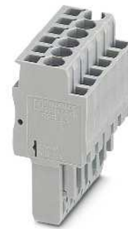
2,5 (4) mm 2 , 24 A, Stecker, Anschluss in Steckrichtung, brückbar
