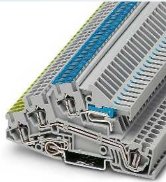
2,5 (4) mm 2 , 20 A, Dreistockklemme, 1 x Außenleiter L, 1 x N-Leiter trennbar, 1 x PE
