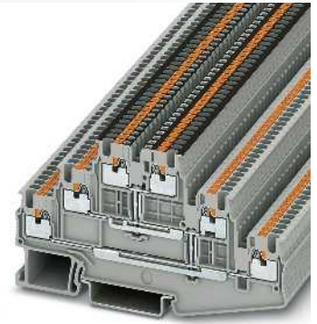
1,5 (1,5) mm 2 , 15 A, Dreistockklemme, Etagen intern verbunden
