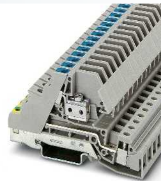
6 (10) mm 2 , 41 A, Dreistockklemme, 1 x Außenleiter L, 1 x N-Leiter trennbar, 1 x PE
