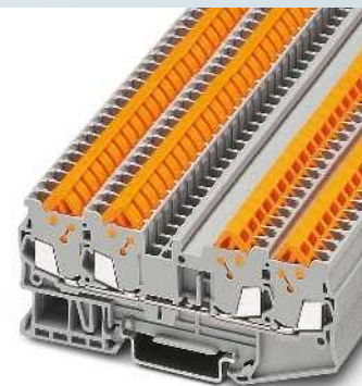
1,5 (1,5) mm 2 , 17,5 A, Durchgangsklemme, 4 Anschlüsse
