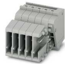
1,5 (1,5) mm 2 , 17,5 A, Kupplung, 2 bis 15-polig
