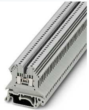
1,5 (1,5) mm 2 , 17,5 A, Durchgangsklemme
