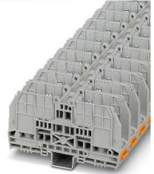
70 (70) mm 2 , 192 A, Durchgangsklemme, zur Tragschienen- und Direktmontage
