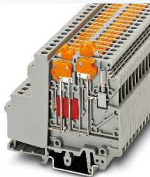
4 (4) mm 2 , 8 A, Durchgangsklemme, 3 Anschlüsse, mit zwei Trennmessern, Prüfbuchschraube
