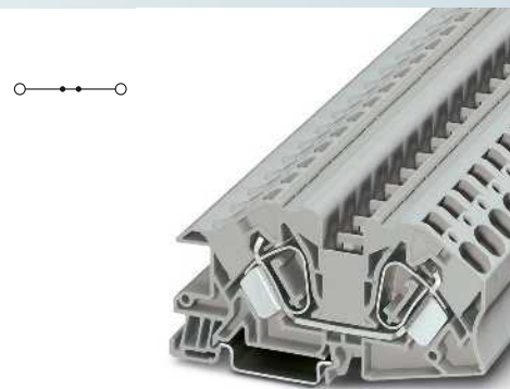
16 (25) mm 2 , 76 A, Durchgangsklemme
