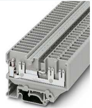
4 (4) mm 2 , 32 A, Durchgangsklemme, mit Schraub- und Flachsteckanschluss
