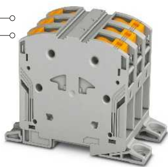
95 (95) mm 2 , 232 A, Klemmenblock, zur Direktmontage
