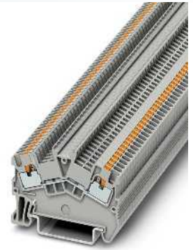
1,5 (1,5) mm 2 , 17,5 A, Durchgangsklemme, 2 Anschlüsse
