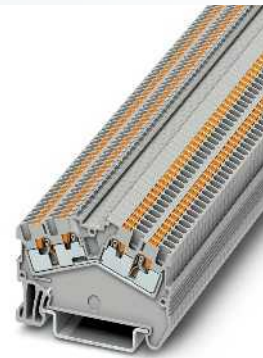
1,5 (1,5) mm 2 , 17,5 A, Durchgangsklemme, 4 Anschlüsse
