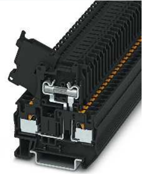
4 (6) mm 2 , 6,3 A, Hebelsicherungsklemme für G-Sicherungen 5 x 20 mm
