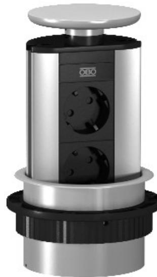
Absenkbar Deskbox mit Anschlusskabel, für den festen Einbau auf einem Tisch, Kunststoff Befestigung Hülse, lackiert entsprechend im Deckel Schatten. Es ist montiert mit einem Bohrloch (Ø102 mm) in der Tischplatte.
