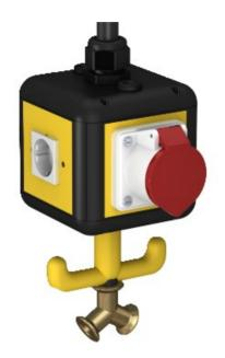
Gehäuse bestückt und vorverdrahtet, mit 1 m Rohr 1/2" und Anschluss für Druckluftschlauch  $13 \times 3.5$  mm und 2-Wege-Verteiler 1/2", mit Aufhängung lug, Griff, Haken und vier cover-Platten.
