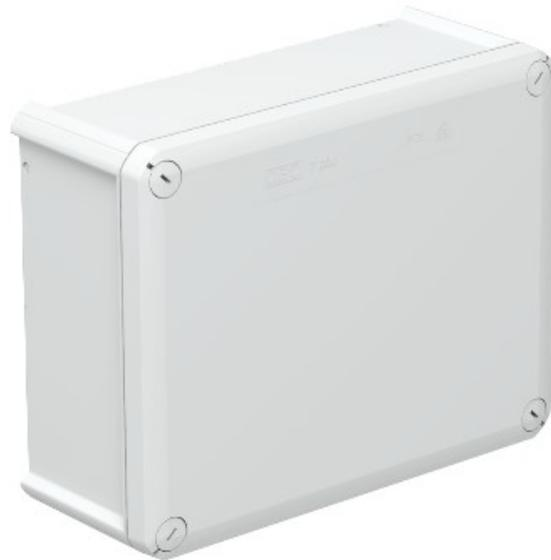
Abzweigkästen sind aus einem thermoplastischen Polypropylen-polymer mit geschlossenen Seitenwänden. Dies bedeutet, dass die erforderlichen öffnungen gemacht werden können, wo immer Sie benötigt werden. EDK-plug-in Dichtungen oder Kabelverschraubungen mit Muttern eingeschoben werden können, die in diese öffnungen, damit Kabel einstecken.
