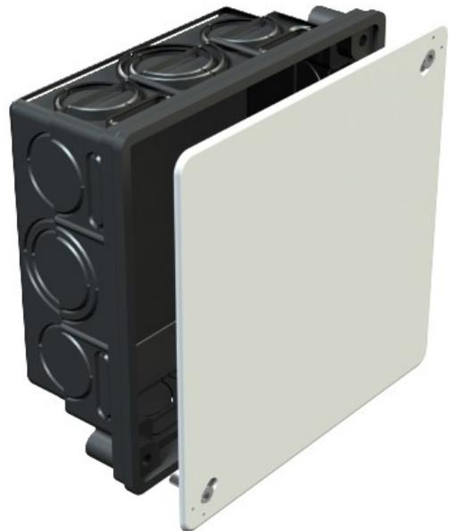
Connection box für den Anschluss von Klemmen, mit Deckel und Deckelschrauben (15 mm), cover-Rand ist bündig, Oberfläche ist aufgeraut, in Verbindung mit Deckel und Deckelschrauben, die Anschlussbuchsen erreichen Sie das VDE-Prüfzeichen nach VDE 060 und werden flammwidrig nach VDE 0471/DIN 695 Teil 2-1, prüftemperatur 750 °C, Schutzart IP20.
