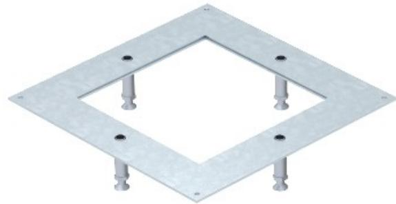
Schwerlast-montagedeckel für UZD350-3 zum Einbau einer quadratischen heavy-duty-Kassette der Nenngröße 9. Mit vier in der Höhe einstellbare heavy-duty unterstützt, dauerhaft verbunden, um die Montage-Deckel. Höhenverstellung Schrauben mit Muttern zum fixieren der Höhe. Einbauöffnung 3 mm Einbauleuchten für die spätere Verblendung Schloss mit deckelblindplatte.
