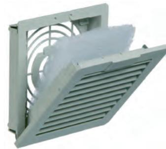
**Beschreibung:** Austrittsfilter zur natürlichen Ventilation oder zur erzwungenen Ventilation in Kombination mit einem Filterlüfter der EF-Serie. Eldon-Austrittsfilter sparen Zeit, da sie mit einem einfachen Click-In System ohne Schrauben montiert werden. Die scharnierte Front kann für einen schnellen und einfachen Filterwechsel geöffnet werden. Filter-Effizienz 88% (91% bei EFA500R5 und größer).
