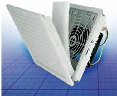
**Beschreibung:** Filterlüfter zur Zwangsventilation. Eldon Filterlüfter sparen Zeit, da sie per Click-In System ohne Schrauben installiert werden. Die scharnierte Front kann einfach geöffnet werden, so dass die Filtermatte schnell und einfach ausgetauscht werden kann. Die Richtung des Luftzugs und der elektrische Anschluss können verändert werden. Filter-Effizienz von 88% (91% für EF500R5 und größer). Buchsenlager. Kugellager für DC-Filterlüfter sowie EF250R5 und größer.
