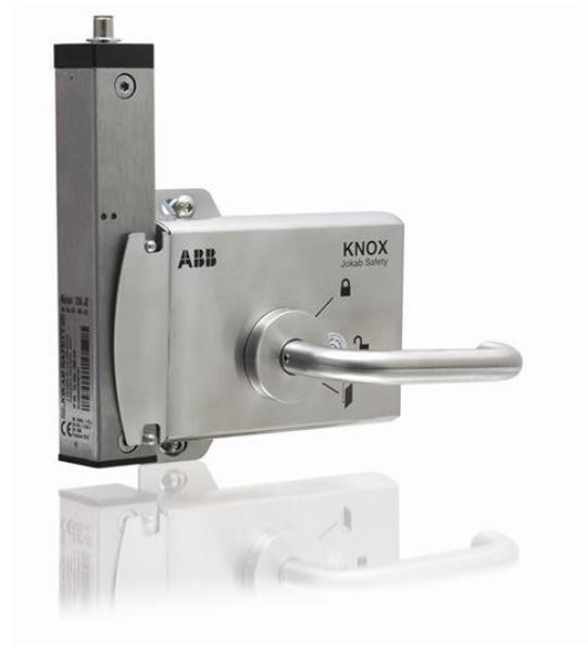
Knox-Tür-Teil für nach innen öffnende Tür mit Scharnieren auf der linken Seite. Mit der option für die manuelle Entriegelung von außen. Lock-Gehäuse ist montiert auf der Innenseite der Tür.
