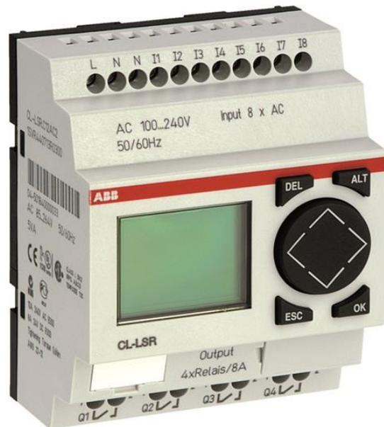
Die CL-LSR.12AC2 ist ein Logik-relais aus dem CL-Bereich. Es hat 8 digitale Eingänge und 4 relais Ausgänge. Die Logik relais arbeitet mit einer Eingangsspannung von 100-240 V AC und verfügt über ein onboard-display und eine Tastatur. 128 Strompfade bei 3 Kontakten in Reihe plus 1 Spule, programmiert werden. Die folgenden Funktionen stehen zur Verfügung: 16 frei editierbare Texte anzeigen, 16-Multifunktions-Zeitrelais, 4 Betriebs-Stunden-Zähler, 16 analogwertvergleicher und Schwellwert-Schalter
