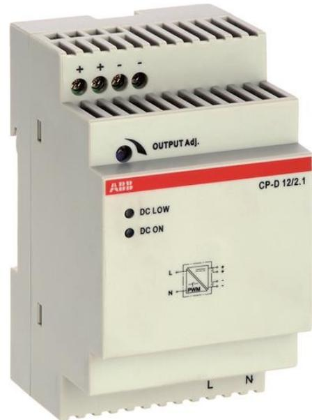
Der CP-D 12/2.1 ist eine Stromversorgung aus der CP-D Reihe. Die primary switch-mode-power-supply bietet eine große Auswahl Eingang von 90-264 V AC und 120-375 V DC, Nenn-Eingangsspannung 100-240 V AC. Die Nennleistung beträgt 30 W, Bemessungs-Ausgangsstrom von 2,1 a bei Einer Ausgangsspannung von 12 V DC. Die Ausgangsspannung ist einstellbar im Bereich von 12 bis 14 V DC. Die Stromversorgung bietet eine U/I-Ausgang Merkmal.
