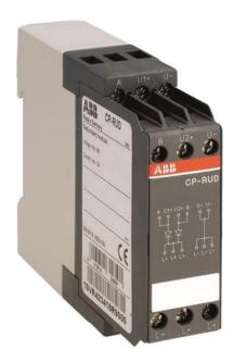
Das CP-RUD ist ein Redundanz-Einheit für CP-E Reihe-Netzteile. Dieses Modul, mit 2 Eingänge je bis zu 2,5 A und einer Leistung bis zu 5 A, ermöglicht die Entkopplung der beiden CP-E Reihe-Netzteile mit einer Leistung < 35 V.
