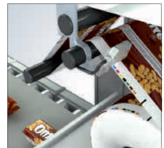
Détection fiable de marques standard ou semi-transparentes à vitesse normale ou élevée
