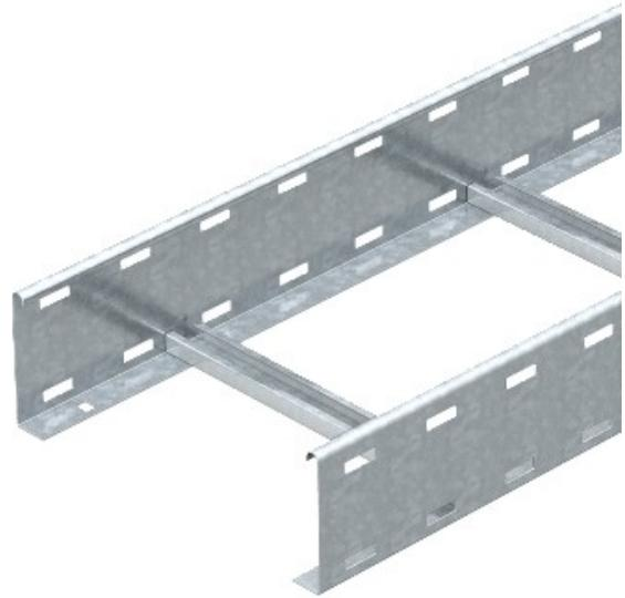
Echelles de côté hauteur 110 mm avec remporté C-profil de barreaux ouvert vers le haut. Roulé de barreaux de renfort et de protection de bord. De fixation pour le support s'effectue à l'aide d'une pince, type LKS 40/4. De correspondance de serrage type de clip 2056/ N.
